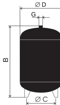
Таблица № 6. Параметры расширительного бака Flexcon CE (6 бар)
