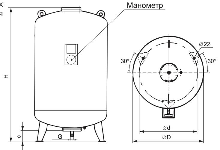
**Таблица № 9. Параметры расширительного бака Flexcon M (вертикальное исполнение)**
