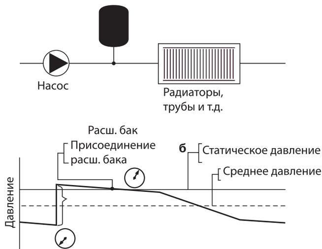
**Заключение:** В замкнутых системах расширительный бак Flexcon следует устанавливать перед всасывающим патрубком насоса. Различия в уровнях установки расширительного бака Flexcon и предохранительного клапана по возможности должны быть сведены к минимуму.
