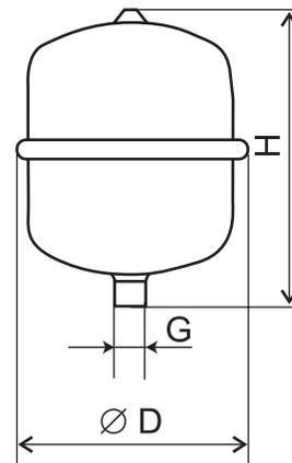
Таблица № 14. Параметры расширительных баков Airfix A
