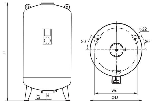
**Таблица № 8. Параметры расширительного бака Flexcon Pro (6 бар)**
