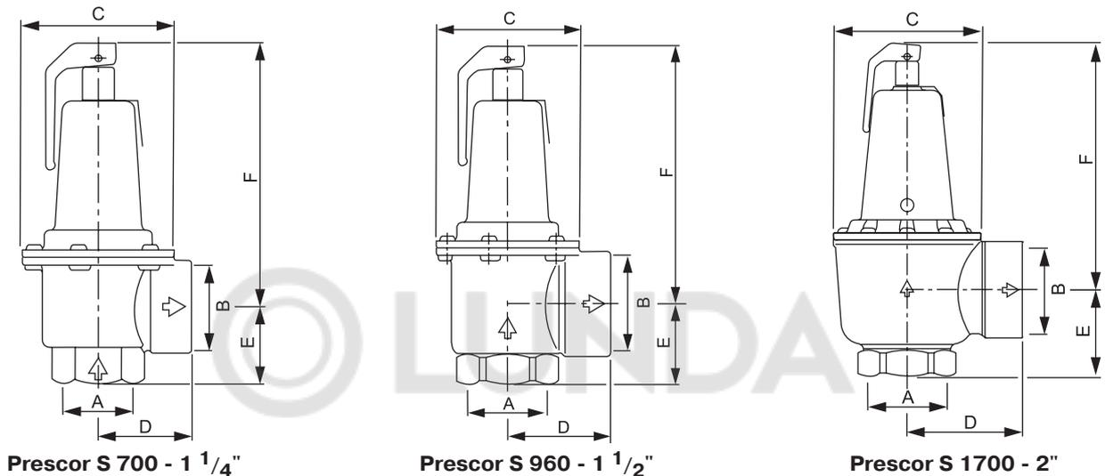
**Таблица № 29. Размеры предохранительных клапанов Prescor S**
