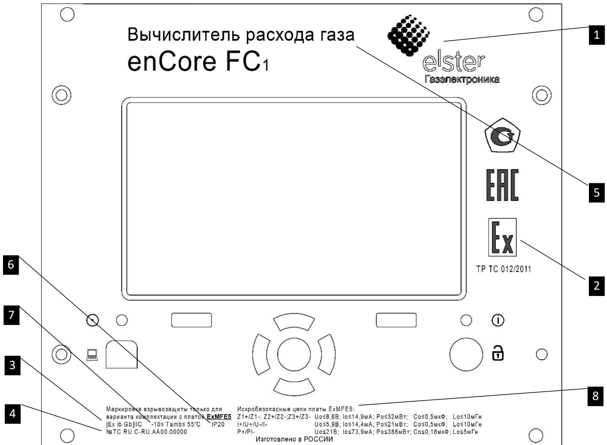
Рисунок 59 Маркировка взрывозащиты на передней панели вычислителя.
