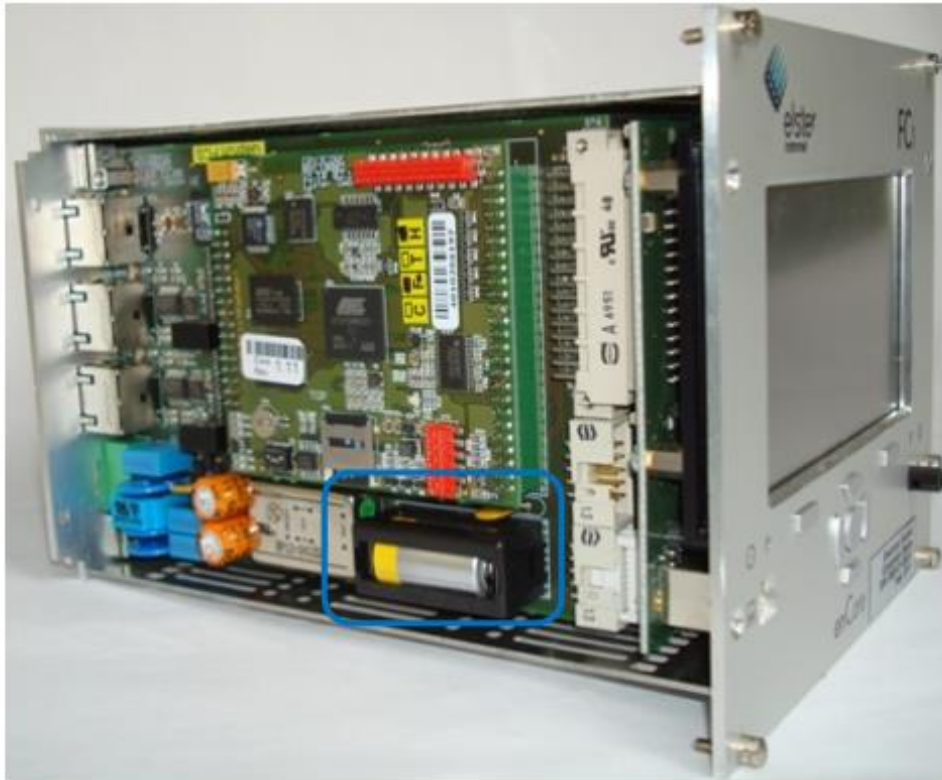
Рисунок 57 Расположение внутренней батареи питания вычислителя
