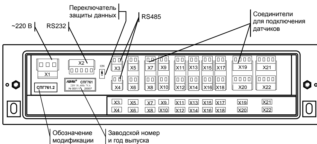
Рисунок 3.2 – Монтажный отсек (крышка снята)
