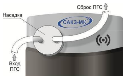
Рисунок Е.2 – Установка насадки для подачи ПГС
