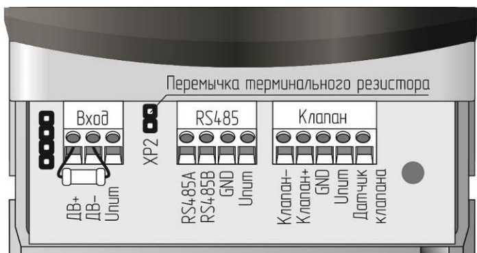
Рисунок В.2 – Расположение разъемов сигнализатора с одним RS485. Сигнализатор СЗ-ЗЕВ не имеет разъема «Клапан».
