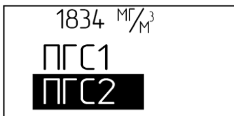
Рисунок 3.6 - Вид индикатора газоанализатора в режиме выбора ПГС, используемый для корректировки показаний
