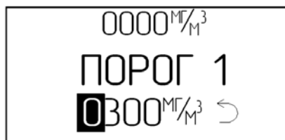
Рисунок 2.6 – Меню редактирования порогового значения срабатывания сигнализации (редактируемый разряд порогового значения выделен инвертированием)
