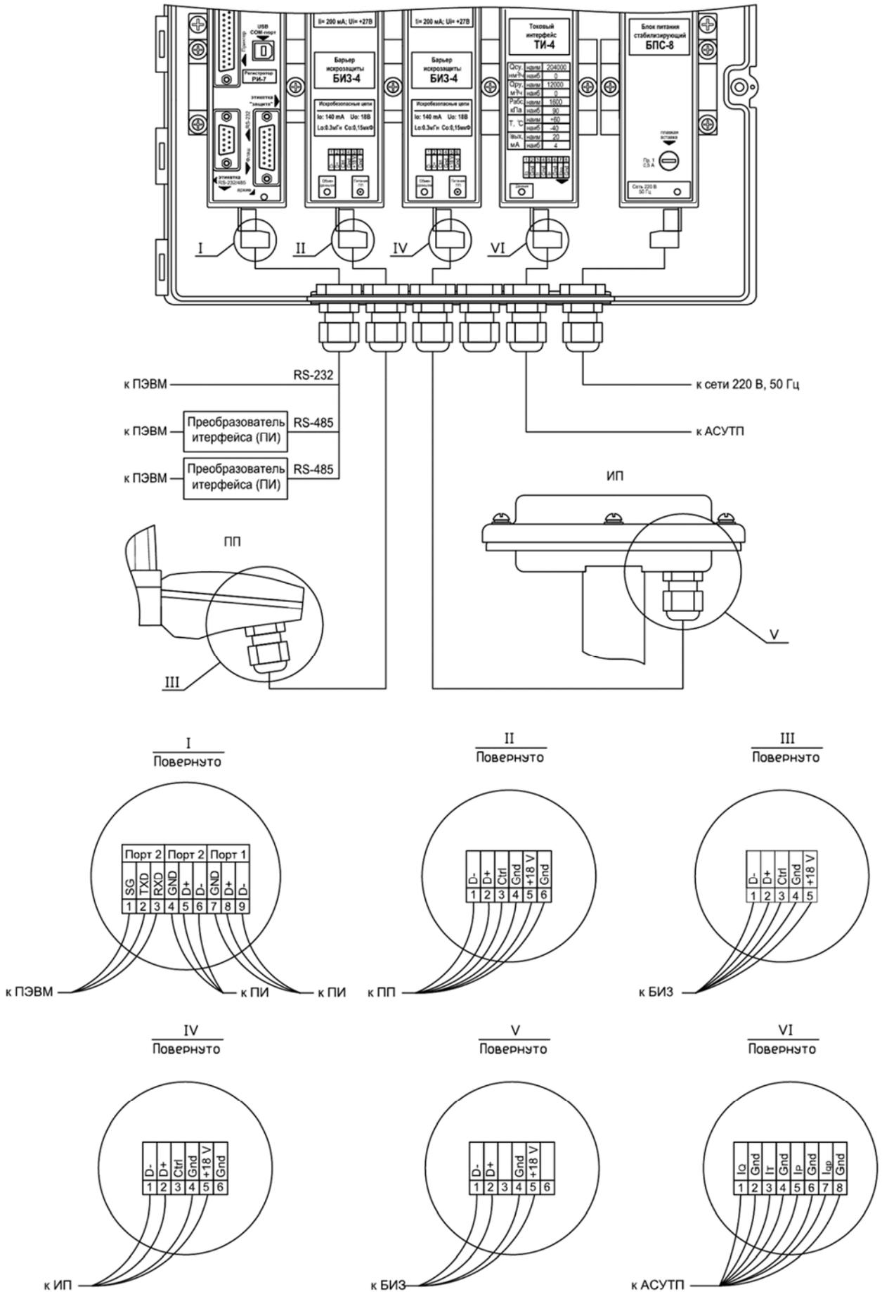
**Схема подключения ПЭВМ к вихревым расходомерам-счетчикам ИРВИС-РС4М с использованием интерфейса RS-232/485**
