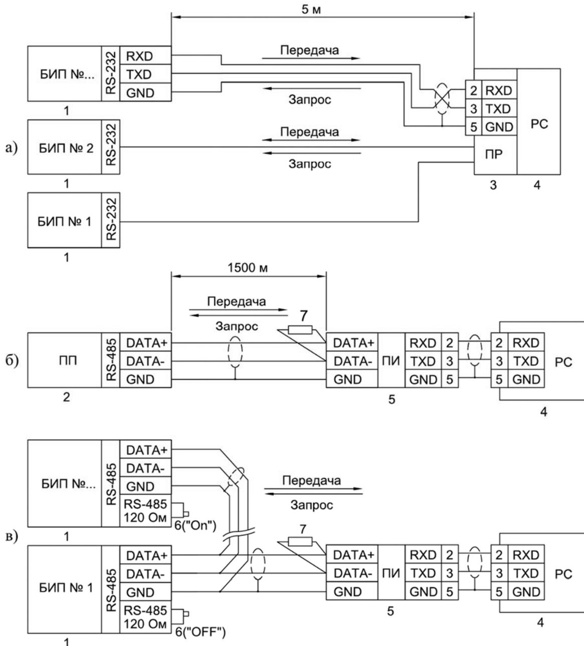
1 – БИП; 2 – ПП; 3 – Плата расширения COM-портов (PCL743B745B – 2 порта, PCL746+ – 4 порта, C186P/HS – 8 портов, C320Turbo – 8...32 порта); 4 – ПЭВМ; 5 – Преобразователь RS-485 <-> RS-232 (ADAM-4520, RIO-7520, ОВЕН АС3-М); 6 – Переключатель; 7 – Согласующий резистор
