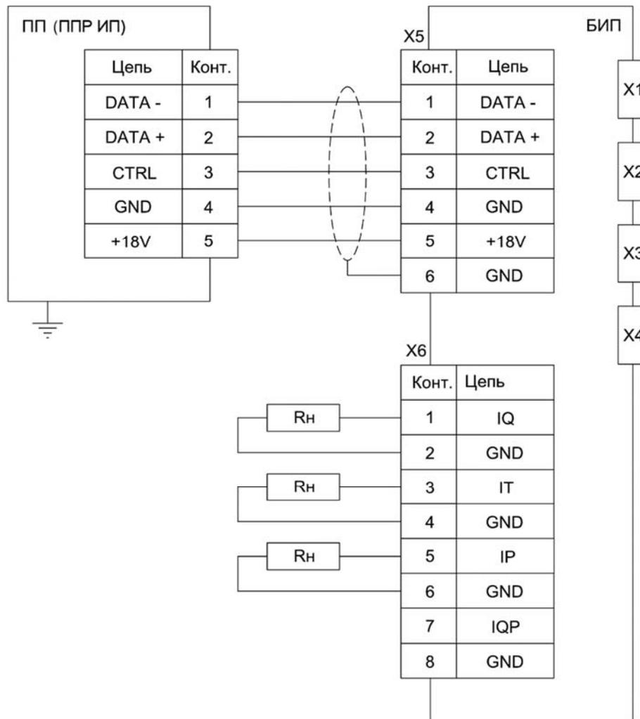
ПП – Первичный преобразователь; БИП – Блок интерфейса и питания; X1 – Разъем подключения флэш-носителя; X2 – Разъем подключения принтера; X3 – Разъем подключения RS-232; X4 – Разъем USB-B для подключения ПК через виртуальный СОМ-порт (только для РИ-7); X5 – Клеммная колодка БИЗ; X6 – Клеммная колодка ТИ
