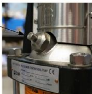
Рис. 6 Пробка на насосе для выпуска воздуха.
