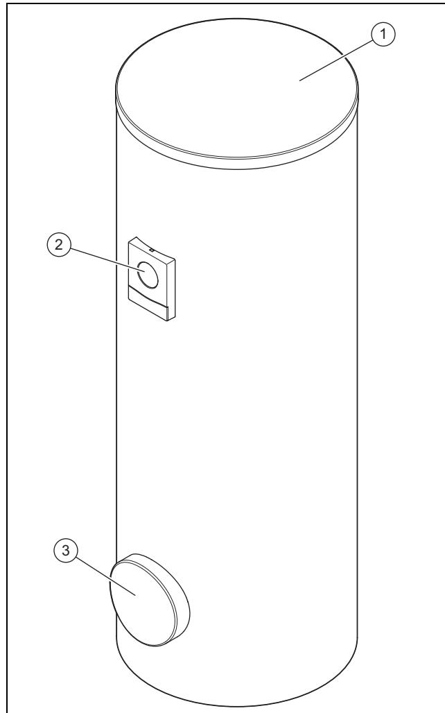
1 Tampa do revestimento      3 Abertura de limpeza
