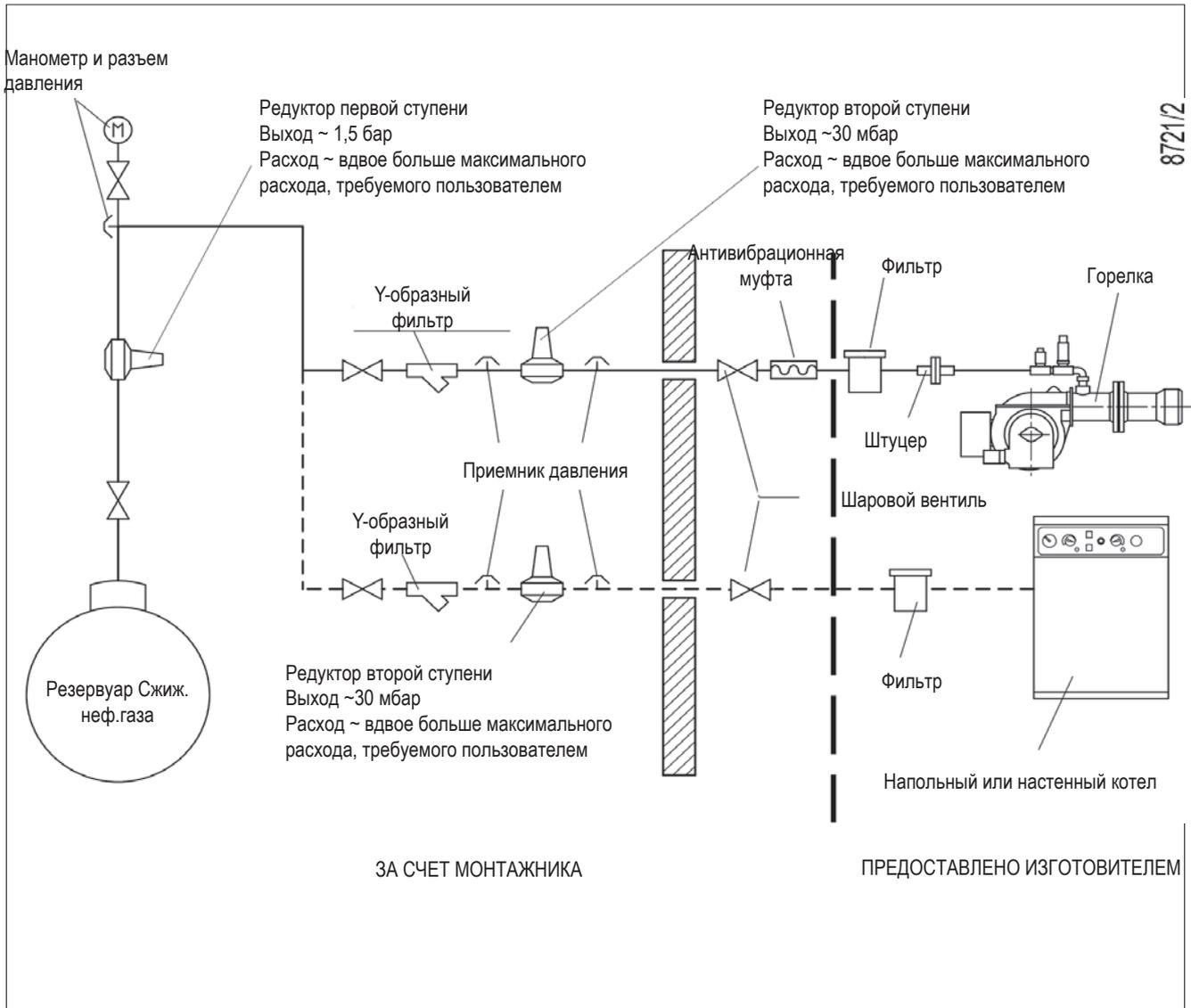
**СХЕМА МОТАЖА С ИСПАРИТЕЛЕМ**
