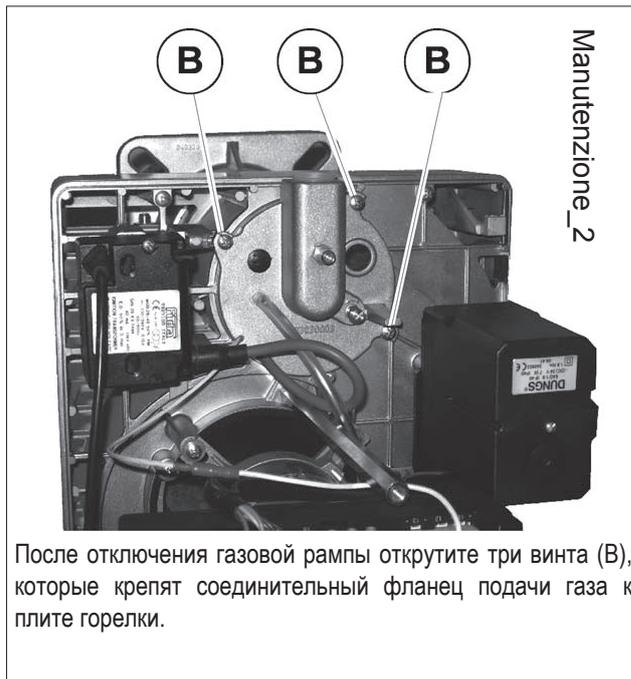
После отключения газовой рампы открутите три винта (B), которые крепят соединительный фланец подачи газа к плите горелки.
