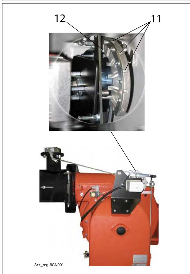
Реле давления воздуха предназначено для обеспечения безопасности (блокирования) автоматики, если давление воздуха отличается от предусмотренного.
