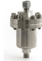
Разделитель сред «жидкость/газ» РПГ предназначен для проведения калибровок и поверок средств измерения давления, не допускающих попадания внутрь жидкости (в том числе пищевого исполнения, кислородного исполнения, специального исполнения). Разделитель устанавливается непосредственно на гидравлическое устройство, требует подключения к источнику питания (баллон сжатого газа или компрессор). Максимальное давление 25 МПа.
