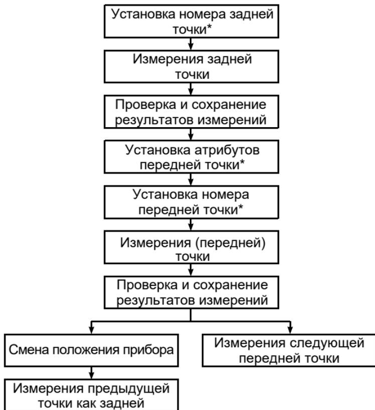
Ниже приводится пример выполнения измерений в режиме определения превышений.
