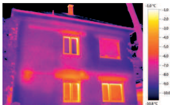
Термограмма с функцией testo ScaleAssist
